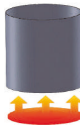
Chauffe par le fond
